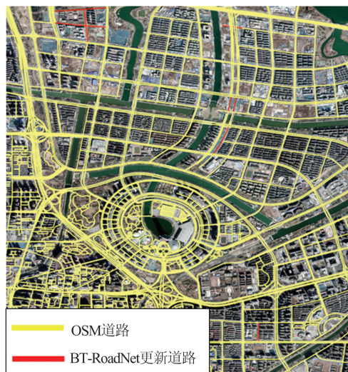
图 2 融合深度学习与导航路网的道路网提取
