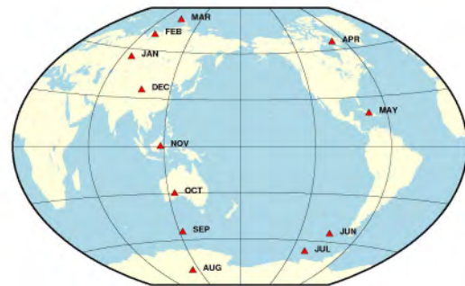
图 4 每年负载力矩在地球表面的运动轨迹 Fig.4 Annual Trajectory of the Load Moment on the Earth Surface
