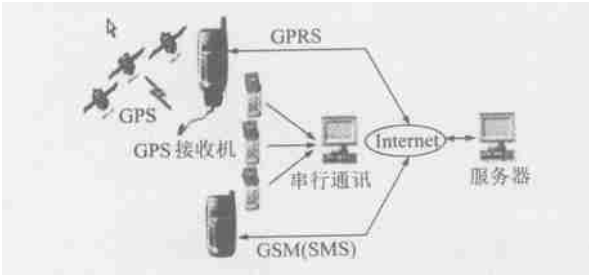
图 1 Java 手机 GPS 数据采集传输系统方式
