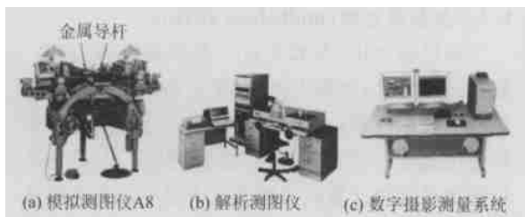
图 1 摄影测量三个发展阶段 的三种典型仪器
