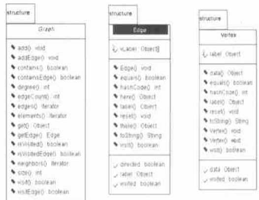
图 1 图、边、顶点的 UML 类图
