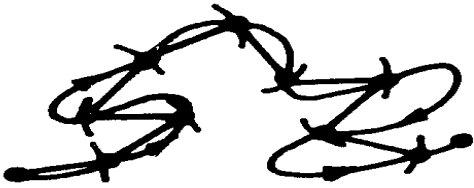
图 4 用量规法量测曲线长度
