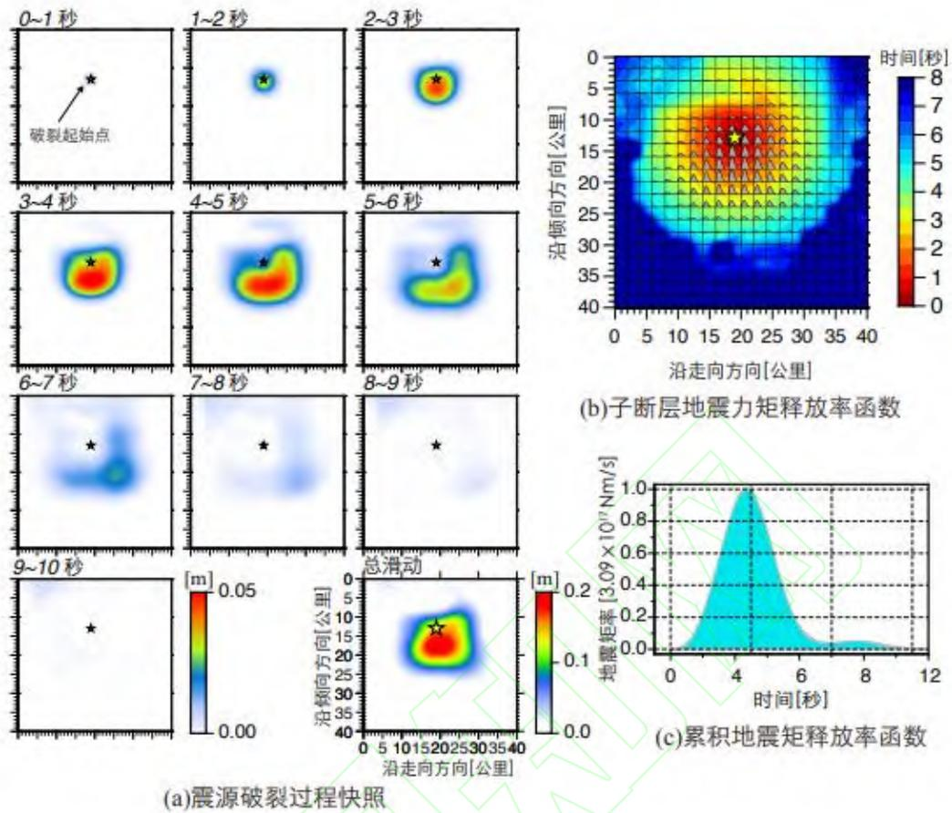
图5 断层面动态破裂图
