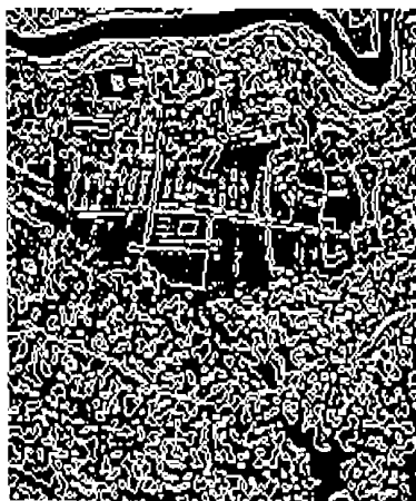
图8 开启运算增强后 LOG 算子提取的边缘
