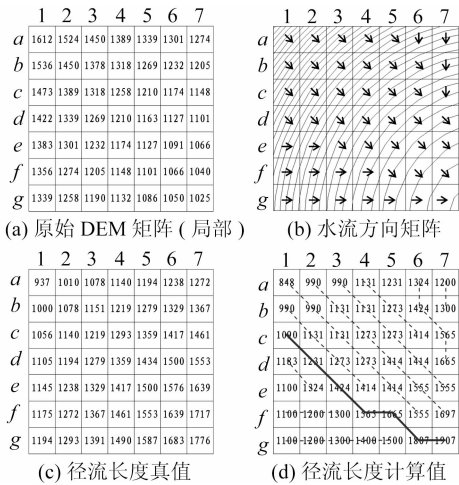
图 5 径流长度累计对计算影响分析 (下半球面,DEM 分辨率:100 m)
