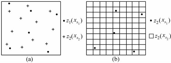
图2 用协同克里金方法,据主采样点集  $\{z_1(x_{s_1})\}$  和次级数据点集  $\{z_2(x_{s_2})\}$  采样数据估计  $z_1(x)$  的值
