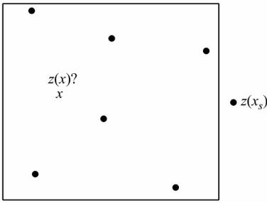
图1 用采样点集  $\{z(x_s)\}$  计算未采样点  $x$  的克里金估计值  $z(x)$
