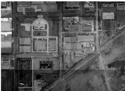
图 8 110 幅立体影像自动生成的正射影像图 Fig. 8 Orthoimage Generated by 110 Stereo Images
