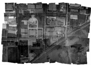
图 6 110 幅立体影像构成的全景拼接图 Fig. 6 Panorama Image Generated by 110 Stereo Images
