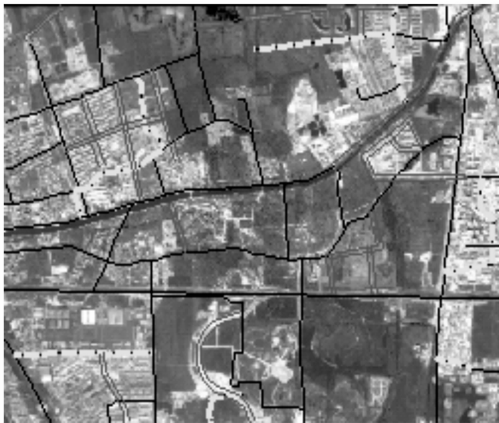
图 7 IKONOS 与 1 : 10 000 道路变化检测结果 Fig. 7 Change Detection Results of IKONOS and 1 : 10 000 Road
