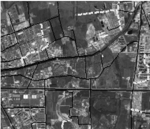
图 6 SPOT5 与 1 : 10 000 道路变化检测结果 Fig. 6 Change Detection Results of SPOT5 and 1 : 10 000 Road
