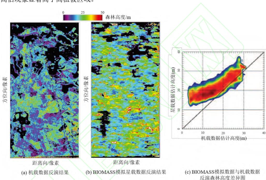
图 4 机载与星载 PolInSAR 数据反演北方针叶林森林高度结果图<sup>[59]</sup>
