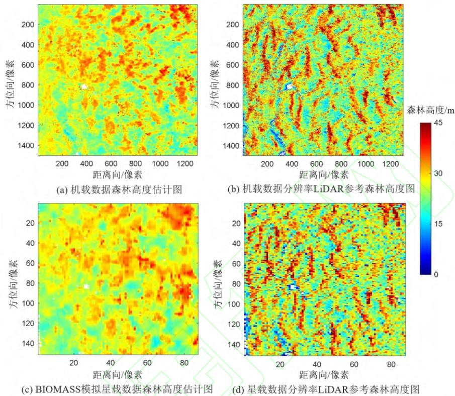
图 2 机载和星载三基线 PolInSAR 反演森林高度图与 LiDAR 森林高度图<sup>[52]</sup>
