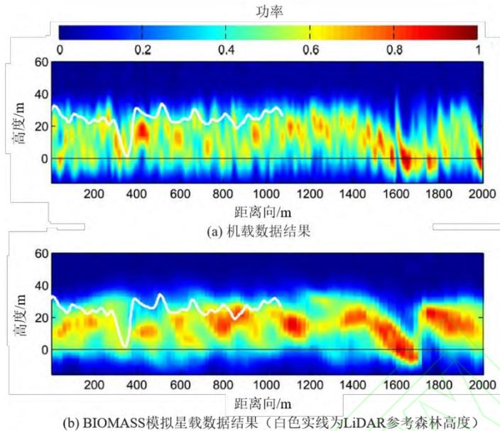
图3 六景机载 SAR 影像和星载 SAR 影像利用 TomoSAR 提取的森林垂直散射剖面图<sup>[54]</sup>
