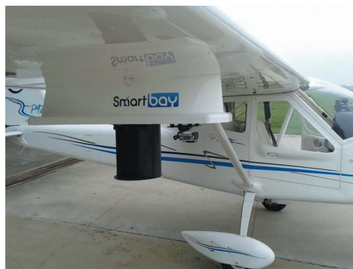
图 2 多极化 GNSS-R 接收机进行飞行遥感实验 [54]
