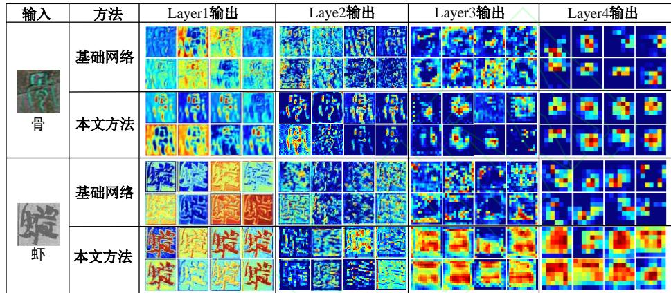
图 8 本文方法与基础网络中各 Layer 输出的热力图
