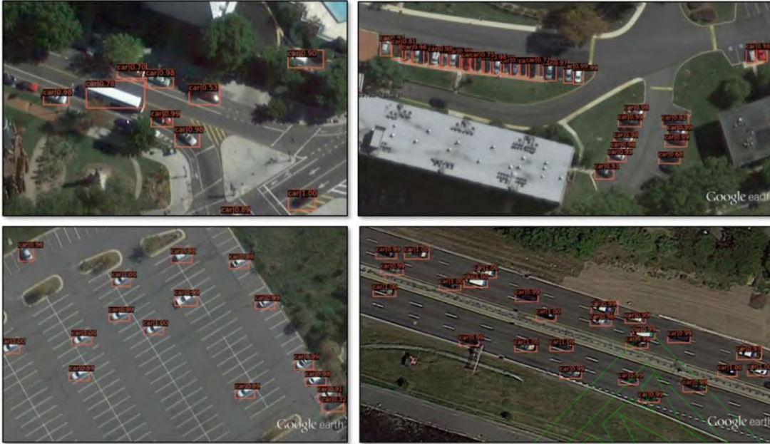
图9 本文方法在只有少量真实标注图像下的目标检测结果（由 Tr-GTA5-Vehilce 预训练和 20 张 UCAS-AOD 微调得到的 Faster R-CNN，在 UCAS-AOD 测试集上测试）
