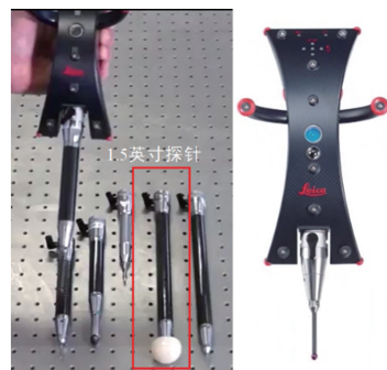
图4 跟踪仪的 T-probe
