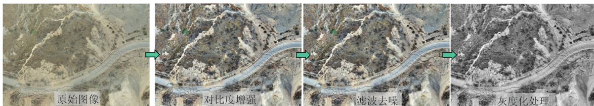
图7 五里坡滑坡正射影像图及预处理结果
