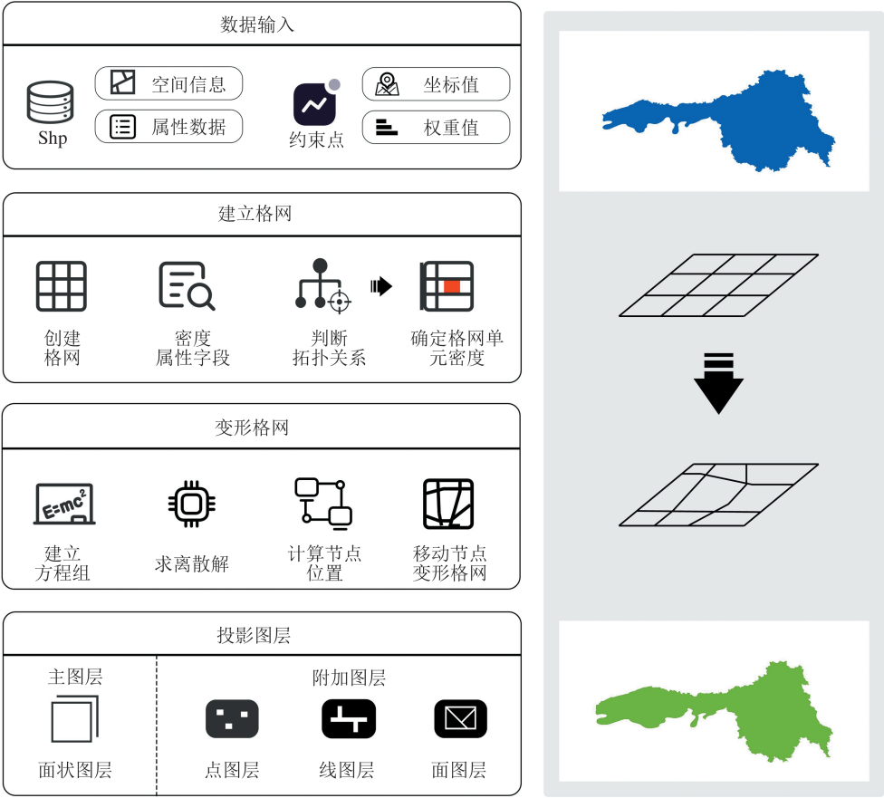
图 2 基于 G-N 算法的地图变换流程 Fig.2 Map Transformation Process Based on G-N Algorithm
