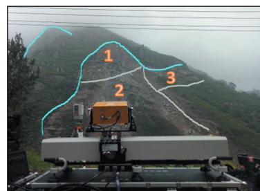
观测近距: 50 m 观测远距: 500 m 横向覆盖范围: 360 m
