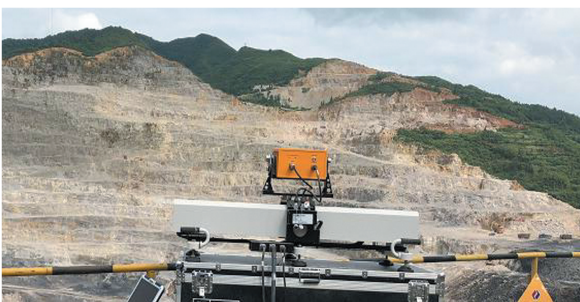
图 1 典型直线扫描地基雷达系统
