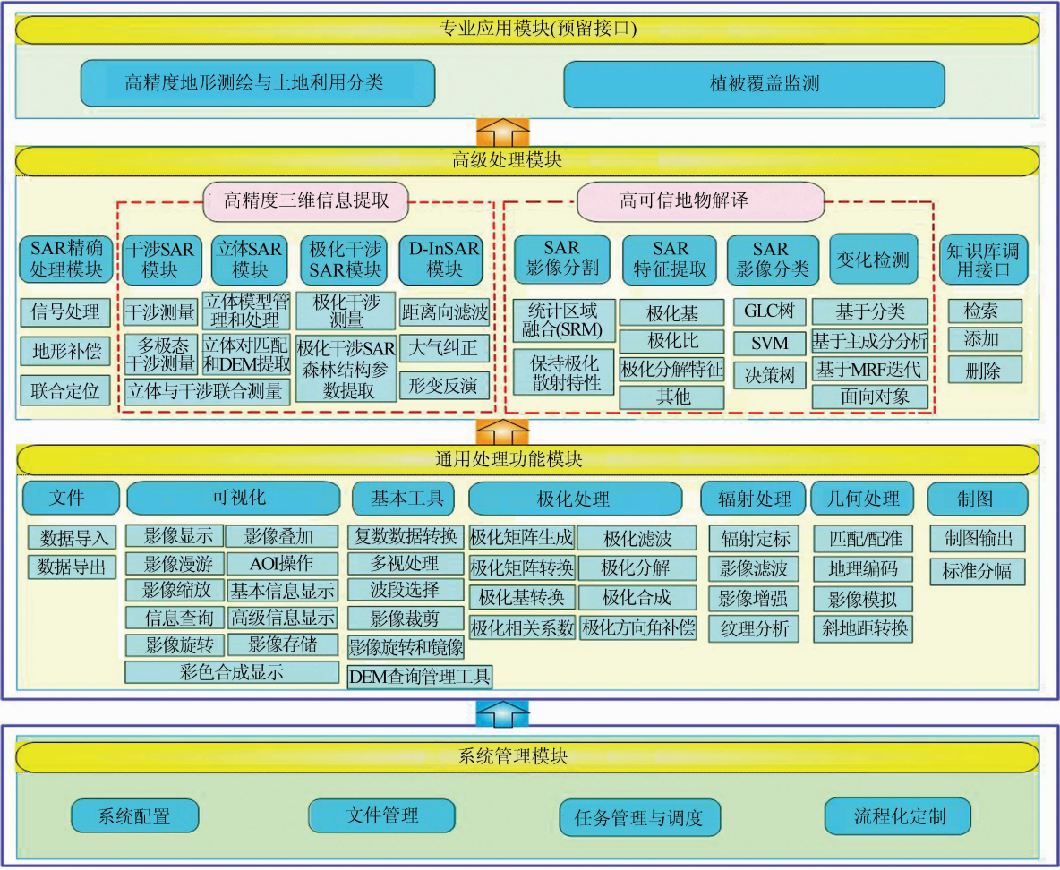
图 6 SAR 影像高性能处理解译系统功能图
