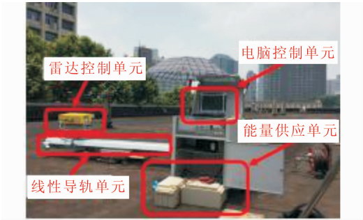
图 1 IBIS-L 系统各个单元构成 Fig. 1 The Components of the IBIS-L System
