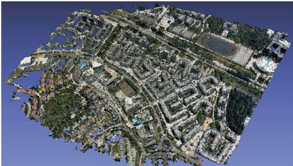
图 7 五镜头共 15 张影像的密集三维点云
