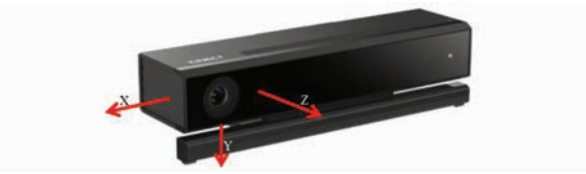
图 1 Kinect 坐标系示意图 Fig. 1 Kinect Coordinate System
