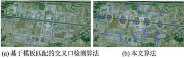
图 4 河南省登封市地区 2.44 m 分辨率 QuickBird 遥感影像道路交叉口检测效果示意图 Fig.4 Detection Results of Road Intersection on 2.44 m Resolution QuickBird Images for Dengfeng City, Henan Province
