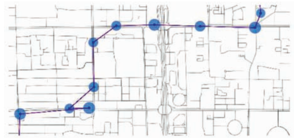
图 4 GPS 误差缓冲区动态生成效果图 Fig. 4 Dynamically Building GPS Error Buffer
