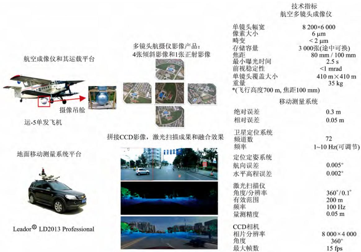
图 1 航空成像平台和地面移动测量系统及平台的数据产品和技术规格
