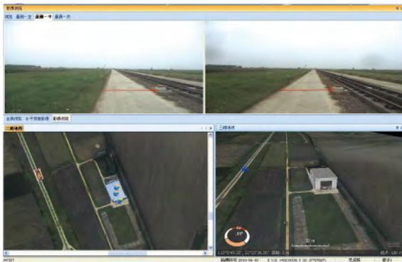
图 5 航空倾斜图像和移动测量系统采集多视图图像的集成结果
