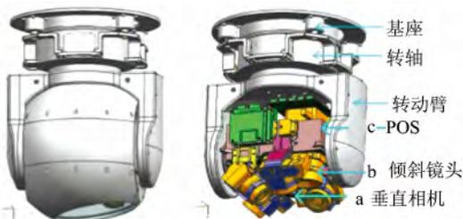
图 2 航空倾斜成像仪结构图
